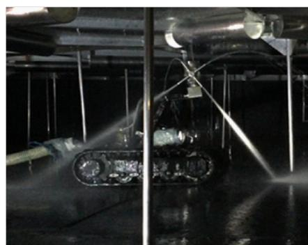
图 3 机器人清洗现场作业
