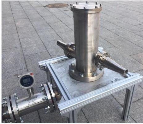
图4 我校自主设计研发的旋转喷射搅拌器测试样机
