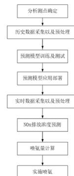
智能喷氨控制方法的流程图
